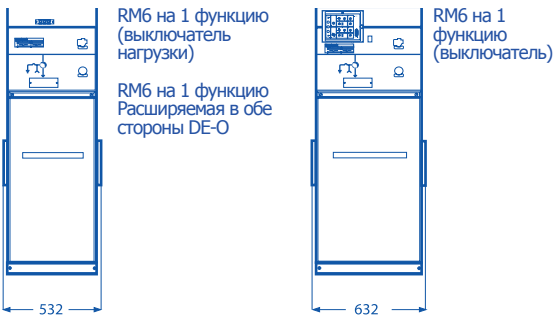
Размеры отдельно стоящих модулей RM6, расширяемых с двух сторон (DE)
